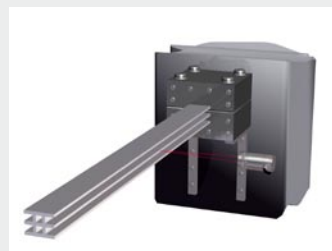
Ekstrüzyon hattında sıcaklık ölçümü
