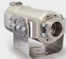
TM-J-TIM Soğutma cekedi (boy 228mm, ø89mm) ayarlanabilir bağlantı aparatı ile TM-JAB-TIM; yüksek sıcaklık kablosu ile tavsiye edilir TM-USBC5H-TIM (200°C 'ye kadar)
